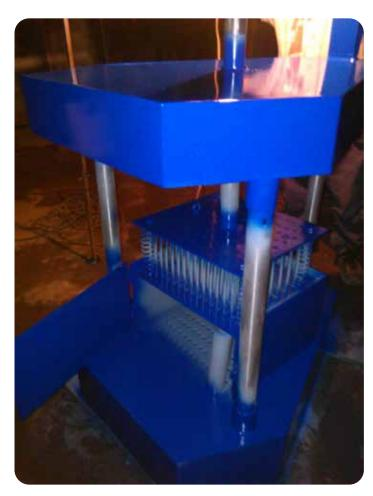
Mecanismo de palanca con 135 púas para perforar el plástico y así optimizar el proceso del vaciado de PET.
