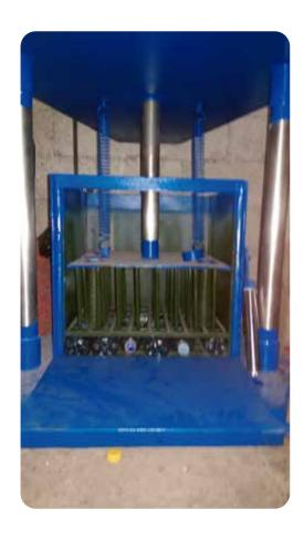
Mecanismo de palanca con 56 púas para perforar el plástico y así optimizar el proceso del vaciado de PET.
