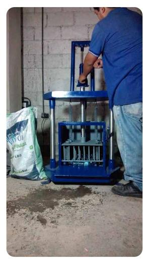
Mecanismo de tricket con 56 púas para perforar el plástico y así optimizar el proceso del vaciado de PET.
