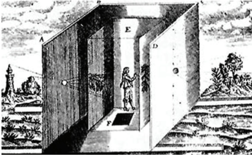
Una ilustración de la cámara oscura y su modo de uso. Fuente: http://www.fotonostra.com/biografias/camaraoscura.htm
