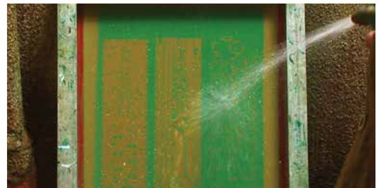
Imagen 11: Revelado de marco de serigrafía
