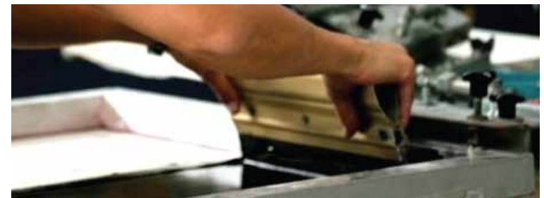
Imagen 13: Impresión y registro en serigrafía
