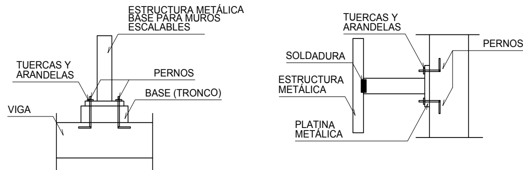
ANCLAJE DE ESTRUCTURA METÁLICA DE MUROS ESCALABLES
