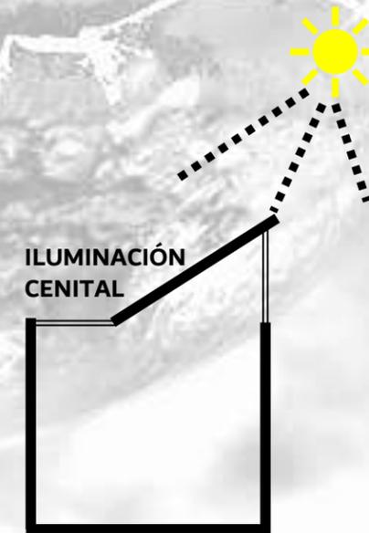
Iluminación cenital permitiendo niveles de iluminación difusa uniformes, distribuidos a través de áreas amplias. Se analizará el tipo de acristalamiento para evitar el deslumbramiento.
