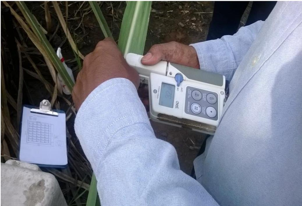
*Figura 6.* Instrumento utilizado en la medición de la clorofila.
