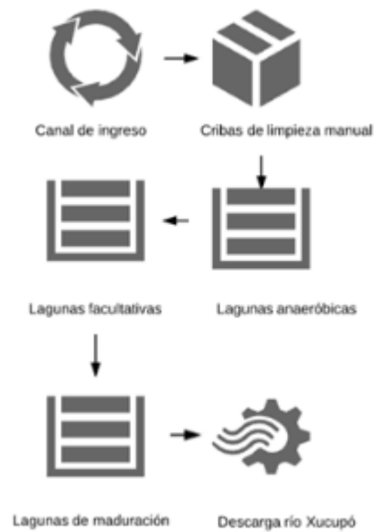
Figura 7. Tratamiento de aguas residuales EMAPET (EMAPET, s.f.)
