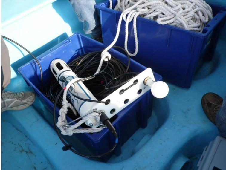
Figura 14. Sonda multiparamétrica para medir PAR
