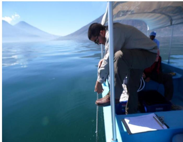
Figura 11. Introducción de la sonda multiparamétrica en el agua
