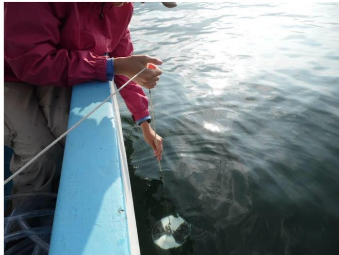
Figura 13. Medición con el disco Secchi
