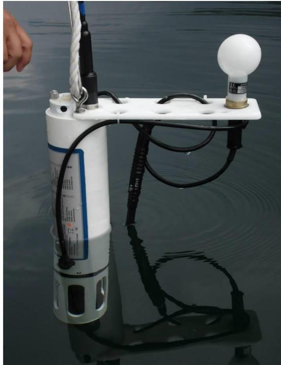
Figura 10. Estabilización de la sonda multiparamétrica que mide PAR
