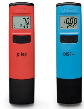
Figura 9. Medidor de pH y Conductividad Eléctrica (JICA, 1998).
