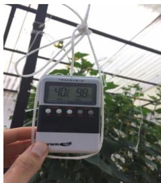
*Figura 16.* Medidor de temperatura y humedad relativa dentro del invernadero de tubos PVC, CPSI, 2017.
