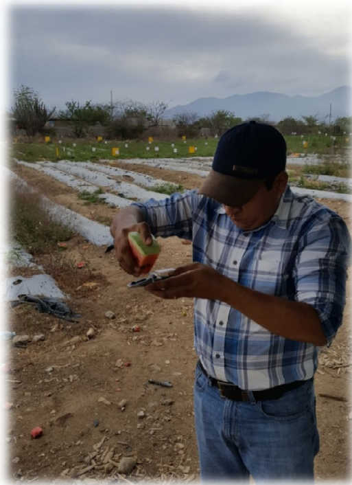
Anexo 6. Muestreo de concentración de azúcares utilizando el refractómetro.
