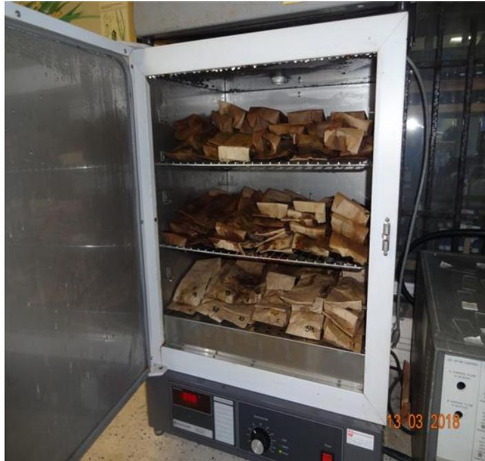
Figura 11. Bolsas en horno de secado.
