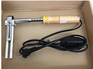
Ilustración 11. Dobladora de acrílico para ángulos rectos. Fuente: https://es.aliexpress.com/item/Acrylic-Right-Angle-benders-Edge-Hot-bending-machine-Luminous-word-bending-machine-advertisement-Acrylic-soldering-iron/32304374021.html
