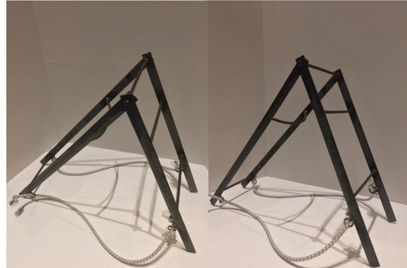
Esta maqueta se realizó con metal negro y varillas con dobleces aplicados para poner a prueba el mecanismo de la articulación y los soportes de la ante pierna que en este caso ya se adaptaron mejor al cuerpo, además se probó utilizar elásticos para realizar un mecanismo en el cual realizar la flexión y extensión fuera más fácil.
