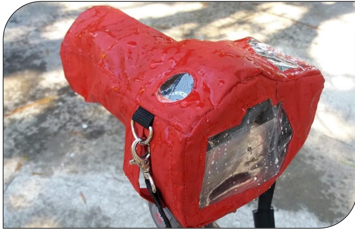
113. Vista general del prototipo luego de ser rociado con agua durante un minuto aproximadamente Fuente: elaboración propia.
