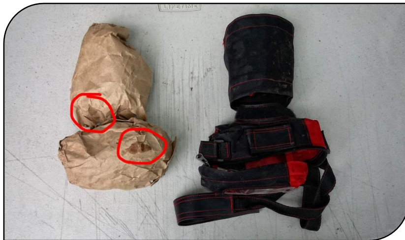
123. Papel craft mojado, lo que indica una filtración de agua Fuente: elaboración propia.
