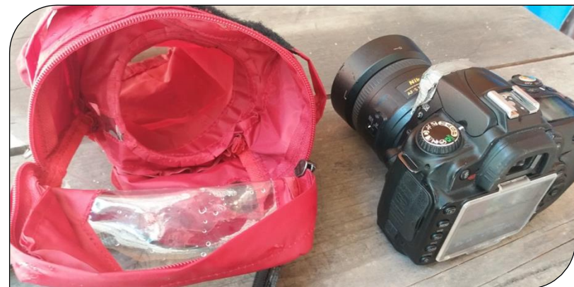
117. Interior del protector y cámara completamente secos luego de la prueba Fuente: elaboración propia.
