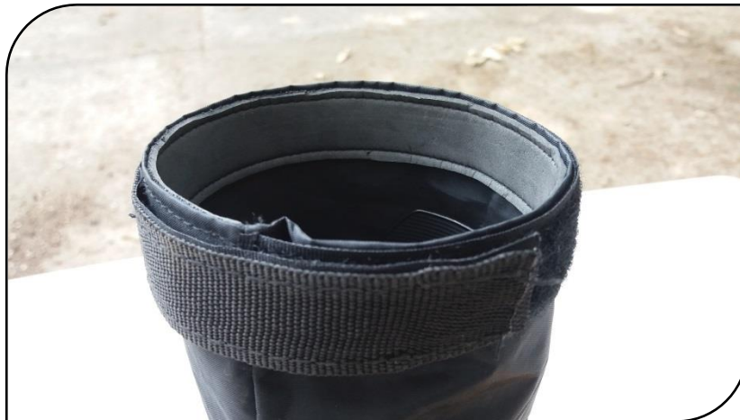
137. Detalle de la espuma que puede verse en su interior y la cinta que cubre el protector por fuera Fuente: elaboración propia.
