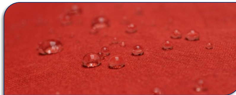
58. Tela para exterior “Sombrella” y su efecto repelente hacia el agua
