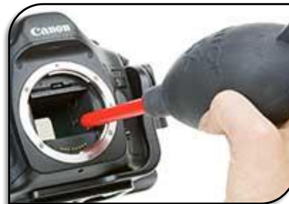
38. Limpieza del sensor con aire
