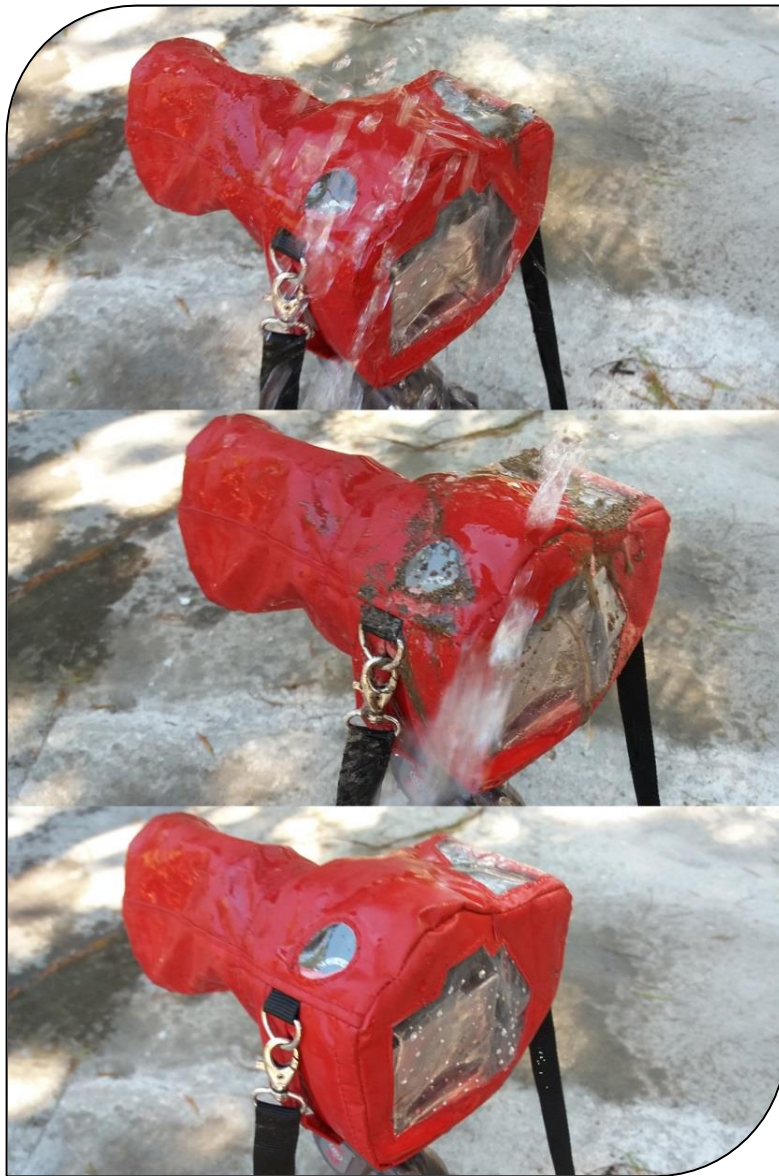
116: Prototipo siendo rociado a presión con agua Fuente: elaboración propia.
