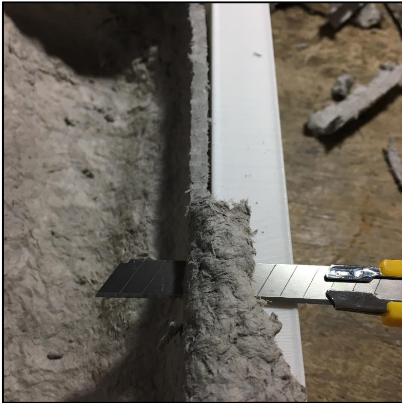
Imagen 98. Corte de bordes sobre el molde, Fuente: Elaboración propia
