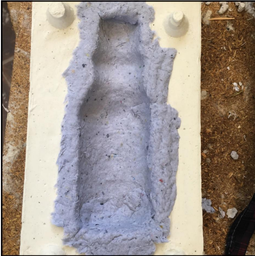
Imagen 48. Pruebas de papel con molde de yeso, Fuente: Elaboración propia
