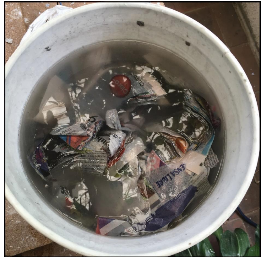
Imagen 56. Mezcla de agua y papel periodico, Fuente: Elaboración propia
