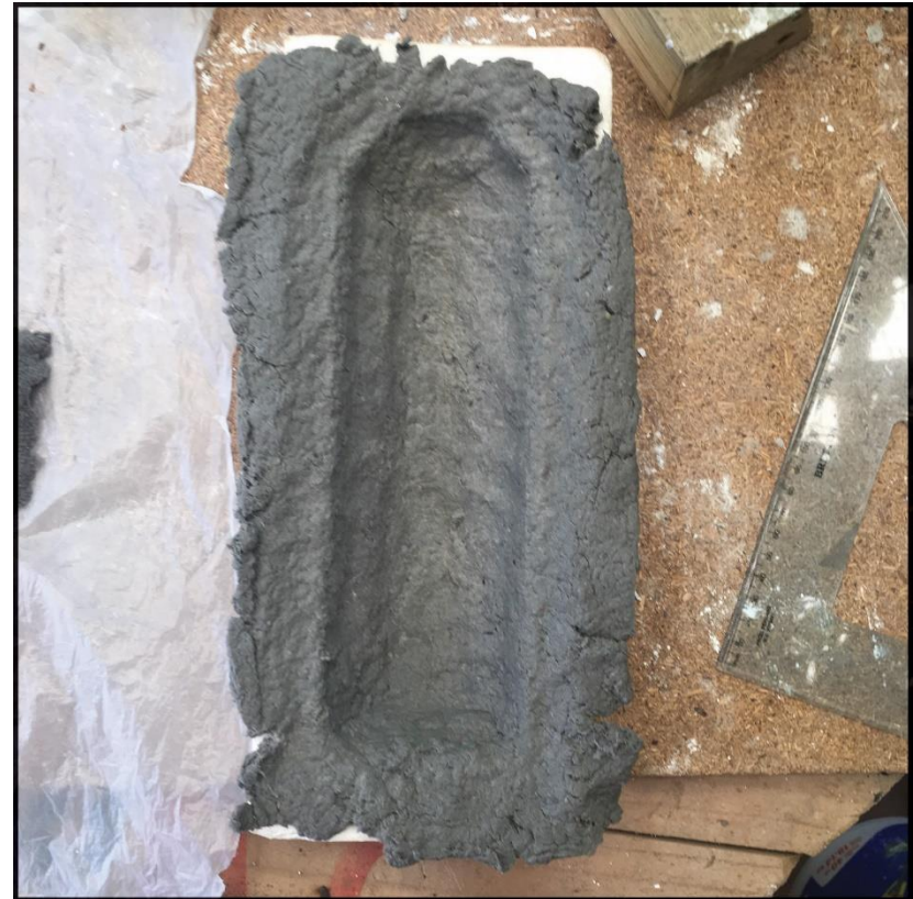
Imagen 64. Aplicación del papel al molde, Fuente: Elaboración propia
