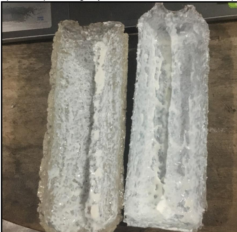
Imagen 86. Prueba de recubrimiento de látex natural, Fuente: Elaboración propia
