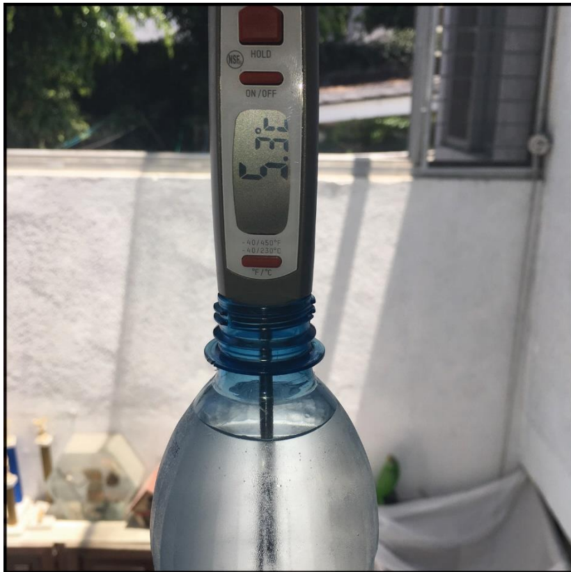
Imagen 88. Lectura de temperatura de botella sin recubrimiento, Fuente: Elaboración propia
