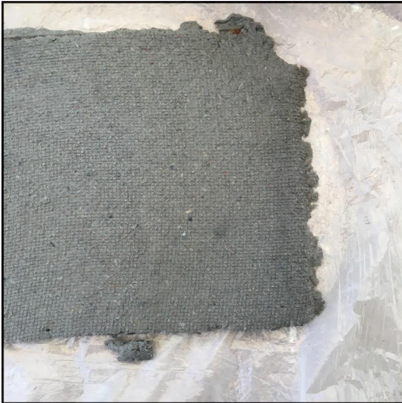
Imagen 63. Plancha de papel comprimido, Fuente: Elaboración propia
