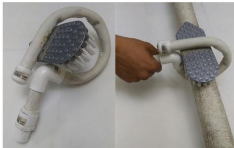
**Prueba real:** Se realizó un prototipo con materiales de bajo costo para validar la efectividad del lavado. Por si sola, la presión del agua no era suficiente, pero con la ayuda de la fricción del cepillo se convertía en un método efectivo y fácil de usar. Se puede apreciar que si se quisiera retirar el tubo para hacer alguna pausa, se tendría que desmontar el rodillo de sus bases. Además de las salpicaduras por los chorros a presión que por la vuelta del aro, apuntan hacia el operario.
