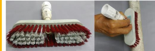
Uso de una "varita" la cual emplea el uso de un cepillo común con una adaptación formal de un tubo termoformado o manguera flexible para la dosificación del agua o solventes.
