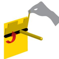
1. Levantar la placa de ajuste de la palanca, ubicada en el cuerpo derecho de la máquina, liberando el movimiento de la palanca de presión del rodillo.
