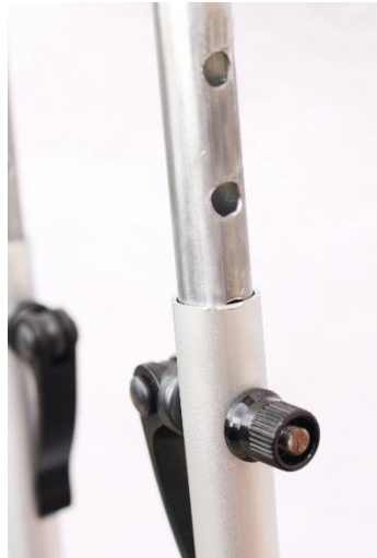
Imagen 57: Tornillos de aguja para regular la altura. Fuente: Propia.
