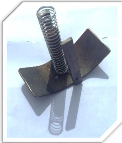
Imagen 45: Taco con resorte en forma de U. Fuente: Propia.
