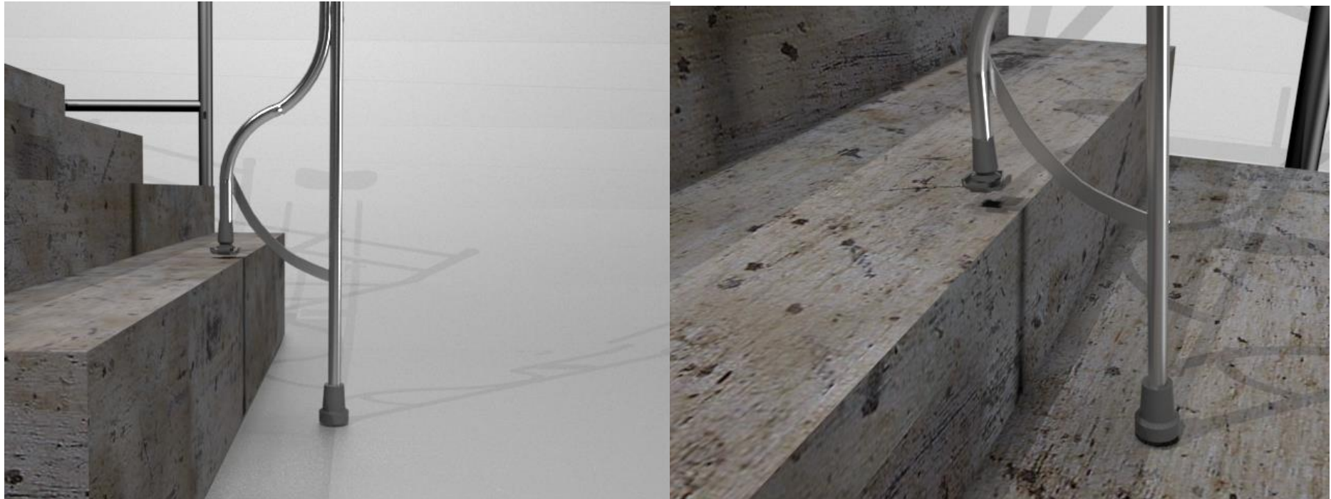
Imagen 55: Render tacos en escaleras. Fuente: Propia.
