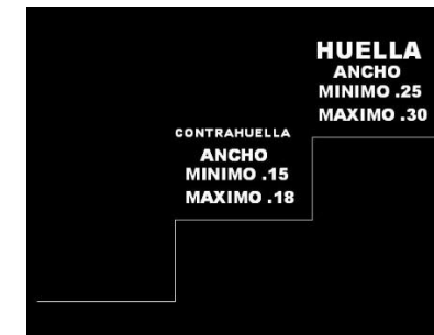
Imagen 8: Medidas máximas y mínimas de huella y contrahuella. Fuente: Dt.dibujotecnico.blogspot.com.
