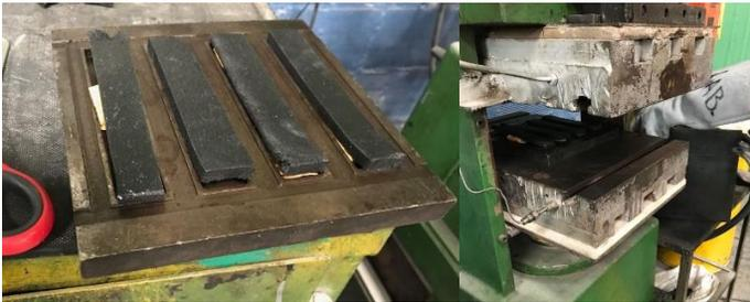
Ilustraciones 120-121: insertan mezclas en el molde – se inserta en prensa. Fuente: imagen propia
