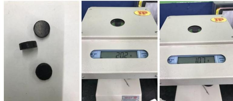
Ilustraciones 175-177: prueba de Abrasión
