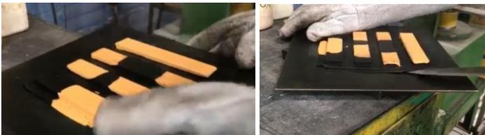
Ilustraciones 122-123: retiro de mezclas del molde – se inserta en prensa
