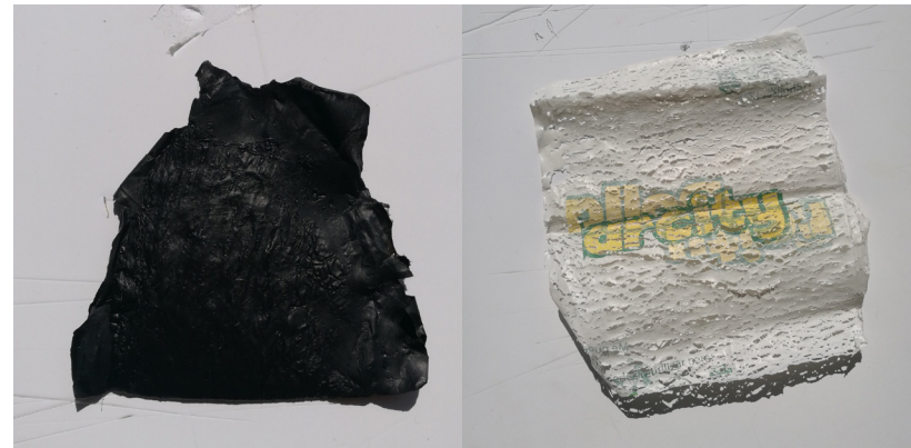
Imagen 27. Bolsas fusionadas con plancha transfer
