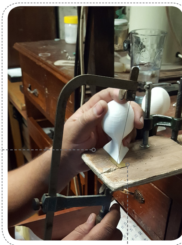
Imagen 60 Uso de herramienta para sujetar piezas pequeñas. Elaboración propia.
