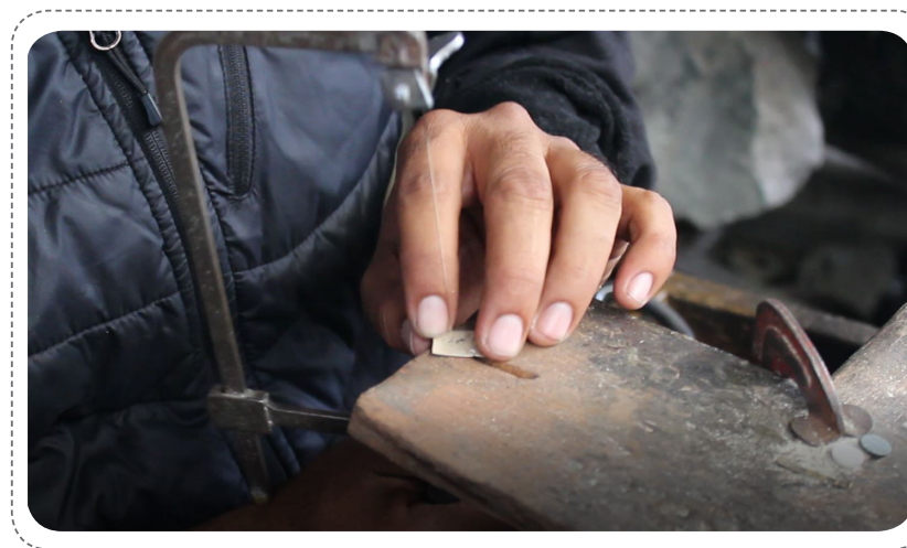
Imagen 36. Postura inadecuada para sujetar pieza de plata. Elaboración propia
