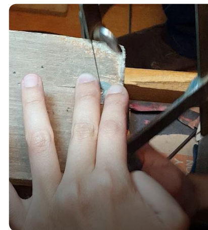
Imagen 40. Posición de dedos para sujetar plata. Elaboración propia.
