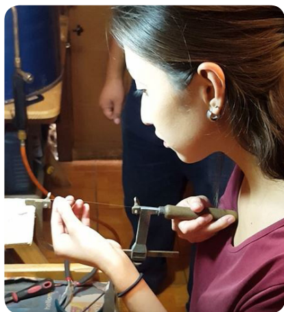
Imagen 37. Ajuste de hoja de sierra. Elaboración propia.
