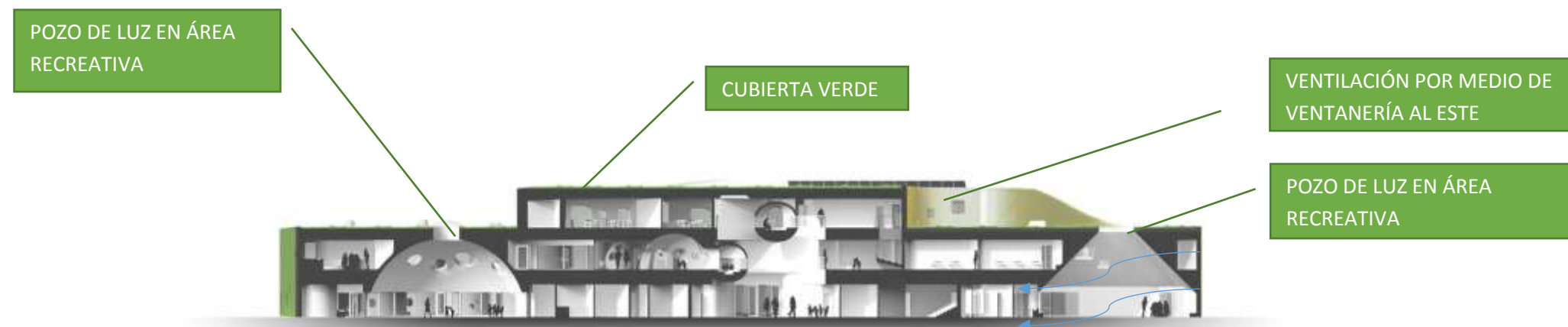
Figura 30. SECCIÓN DEL EDIFICIO. Fuente: Elaboración propia, 2017.
