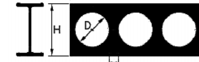
DETALLE DE VIGAS ALVEOLARES Fuente: http://www.construccion.com/espanol/productos/estructuras/perfiles_laminados_en_caliente/vigas_alveolares/acb_vigas_alveolares
