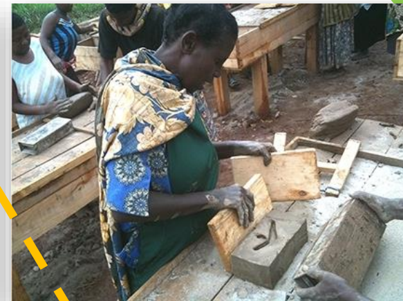
Fabricación de ladrillos para el centro de oportunidad para la mujer. Fuente: https://auroraprise.com/es/aurora/articulo/features/10334/un-claro-sentido-del-lugar/2017
