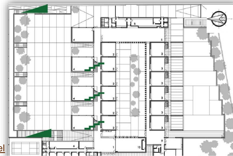
Figura 73. Planta circulaciones verticales Fuente: Fernandez Soler Monrabal Arquitectos, 2012 Imagen modificada por el autor
