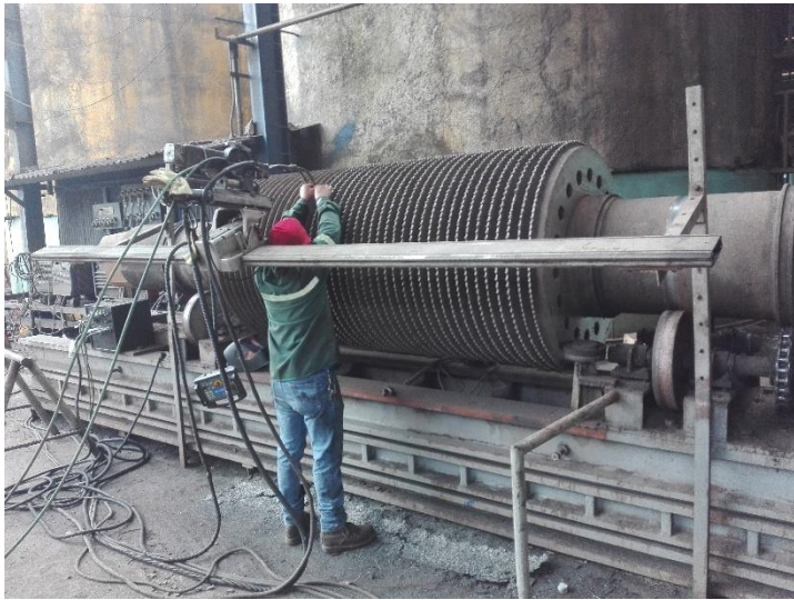
Imagen No. 13. Soldadura de molino Fotografía: Elaboración propia
