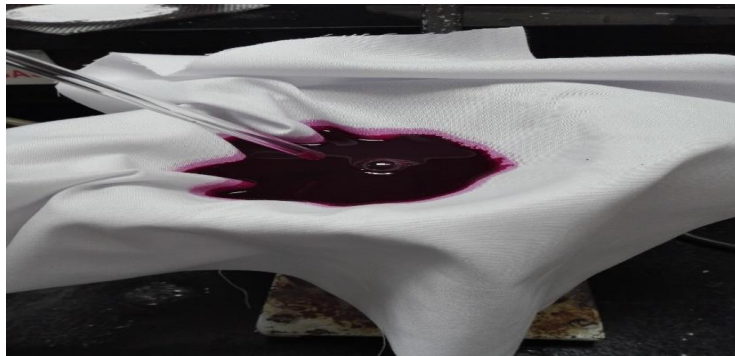
Figura No.25 Filtración del colorante para eliminar biomasa resultante de la fermentación.
