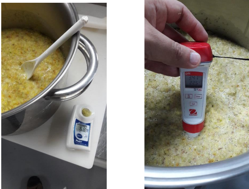
Figura No. 31: Medición inicial de Grados Brix y pH para las muestras.
