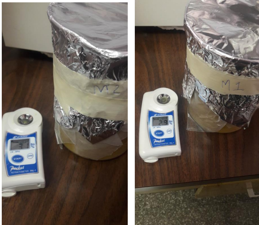
Figura No. 35: Medición de Grados Brix durante la fermentación.
