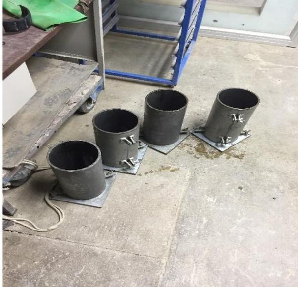
*Figura 30: cilindros utilizados para mezcla.
