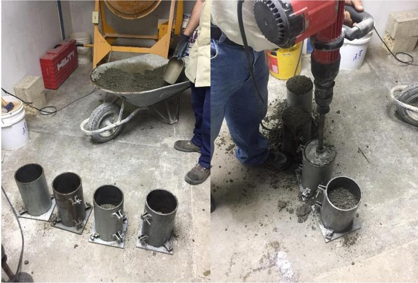
*Figura 32: hechura de cilindros y vibro compactadora aplicada a cilindros.
