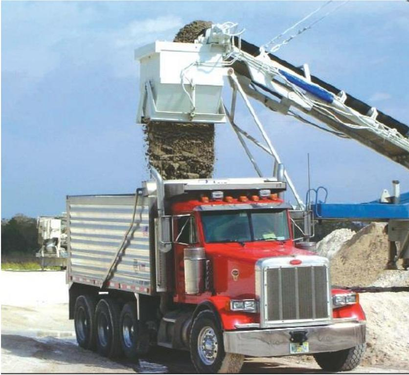
*Figura 15: camiones para transportar mezcla CCR.
