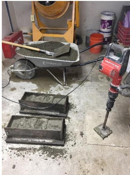
*Figura 39: hechura de vigas y vibro compactadora aplicada a vigas.
