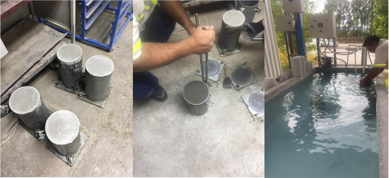
Figura 34: desencofrado de cilindros y la colocación de estos en piletas para su fraguado.
