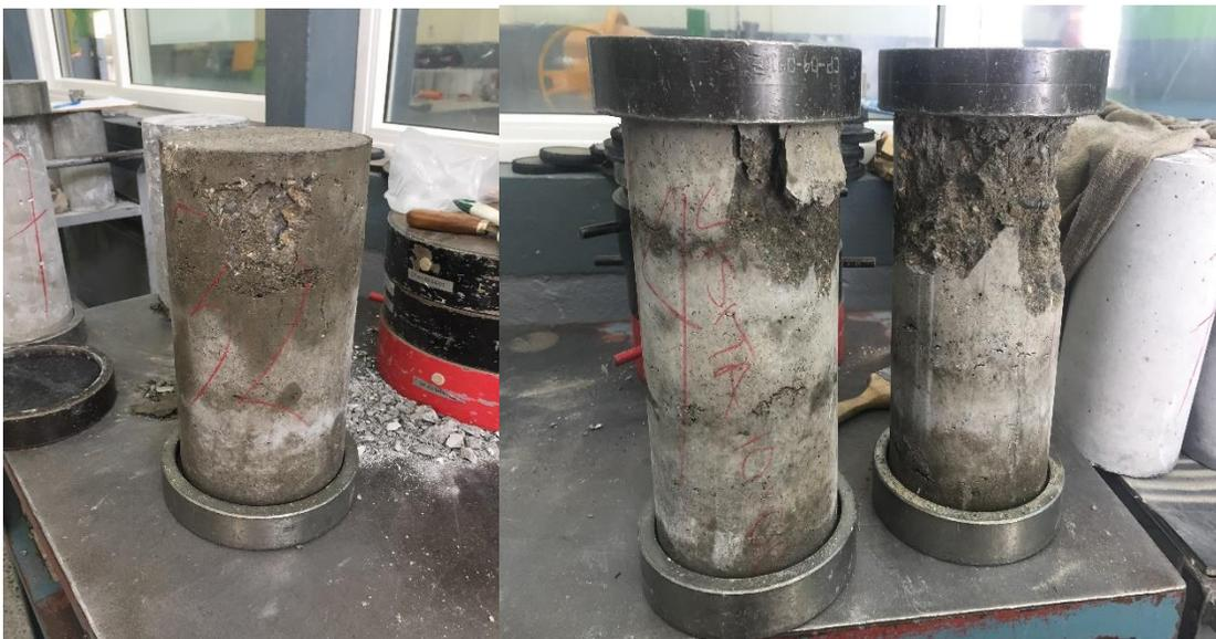
Figura 35: prueba resistencia a compresión de cilindros a 7 días y 28 días.
