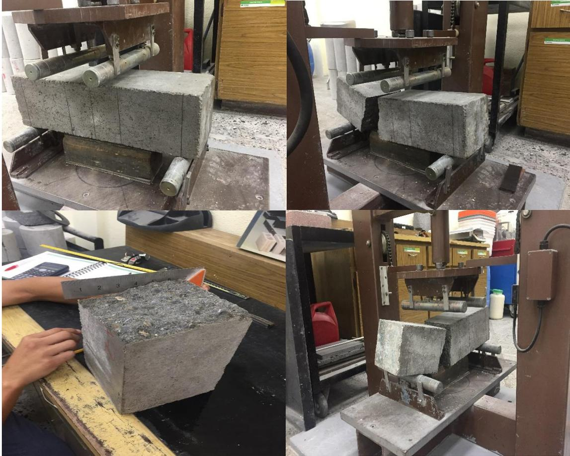
Figura 41: prueba Modulo de ruptura mezcla CCR a 7 días y 28 días.
