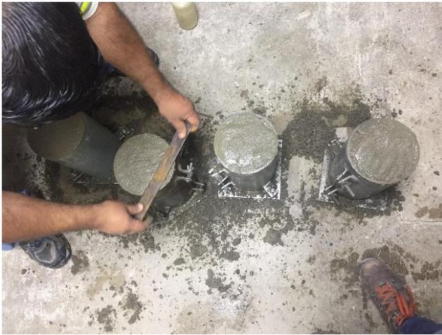
*Figura 33: nivelación final de cilindros.
