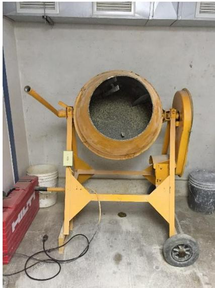
*Figura 38: mezcladora y mezcla CCR para ensayo de vigas.
