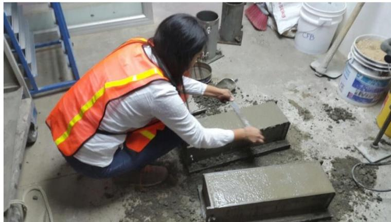
*Figura 40: nivelación final de vigas.
