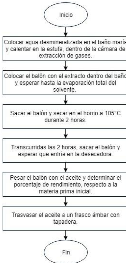
Diagrama 3. Proceso de evaporación del solvente
