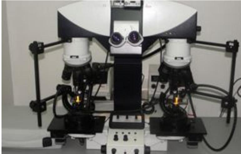
Figura 10. Microscopio de visión simultánea.<sup>40</sup>
