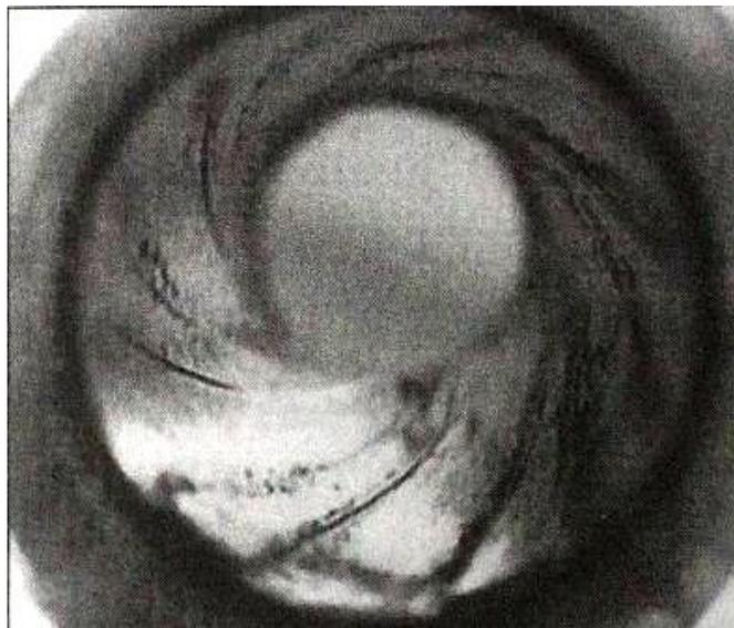
Figura 12. Ánima estriada de un cañón visto por dentro.<sup>73</sup>
