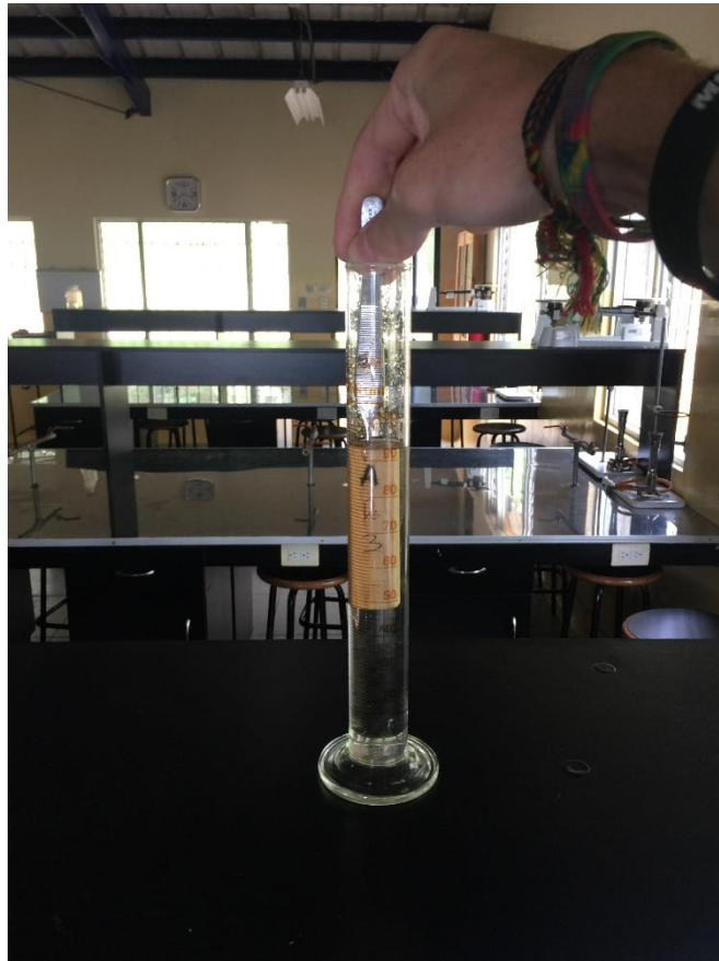
Figura 8. Pieza dentro de una probeta para determinar el nivel desplazado en mililitros. .
