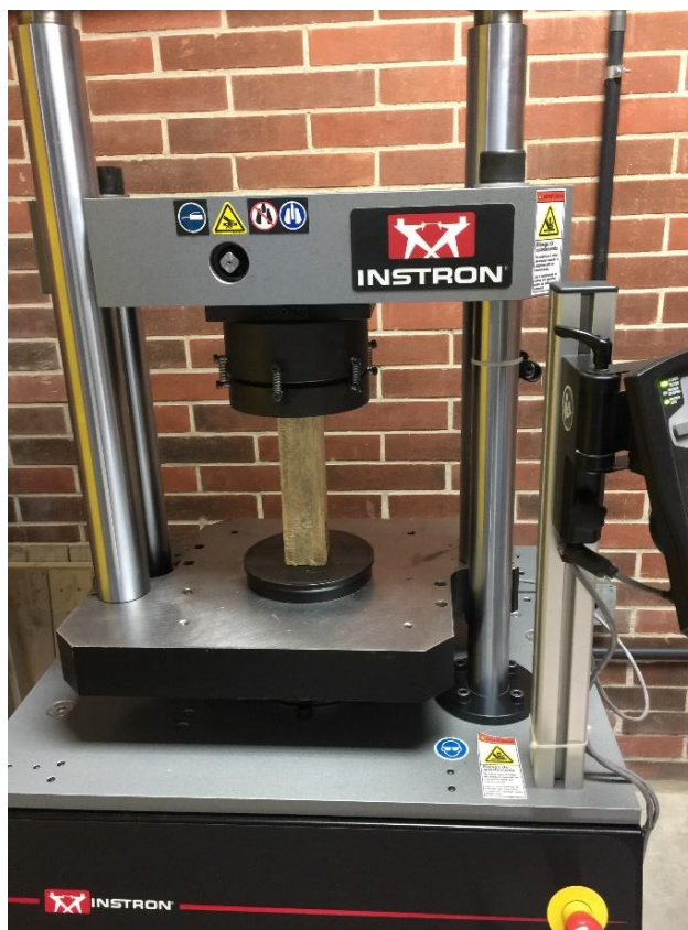
Figura 15. Ensayo de compresión paralela a la fibra en la maquina universal. 15
