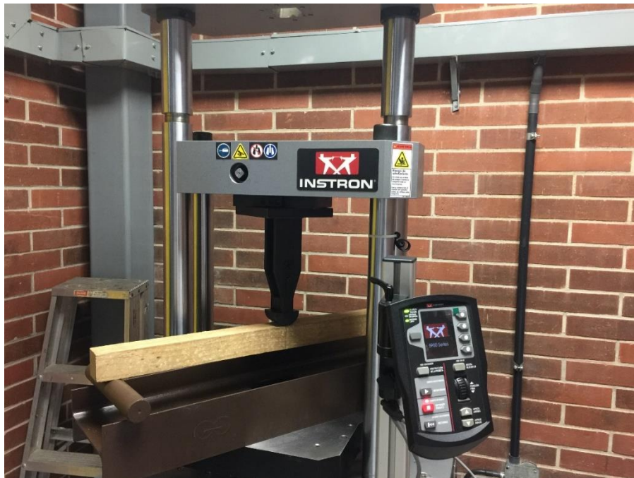
Figura 11. Ensayo de flexión estática, 70 cm de luz entre apoyos y 3 cm del apoyo hacia el extremo..
