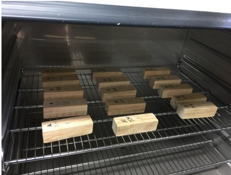
Figura 7. Probetas después de 24 horas de secado y listas para determinar su peso seco.
