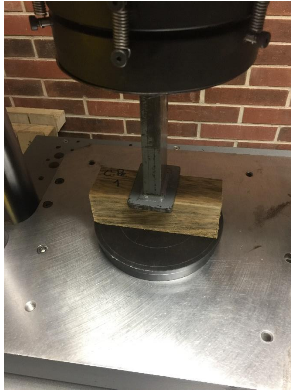
Figura 18. Ensayo de compresión perpendicular a la fibra en la maquina universal. 18
