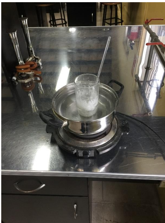
Figura 3. Parafina para cubrir las piezas o probetas. Se puede observar cómo se está calentando dicha sustancia. ,
