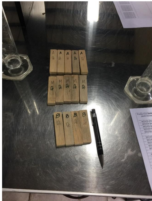
Figura 2. Probetas para determinar densidad de cada tratamiento del experimento. (Denotadas A=sección apical, M=sección media, B=sección basal).
