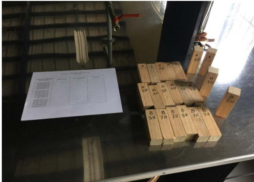
Figura 4. Probetas para la determinación de porcentaje de humedad. .
