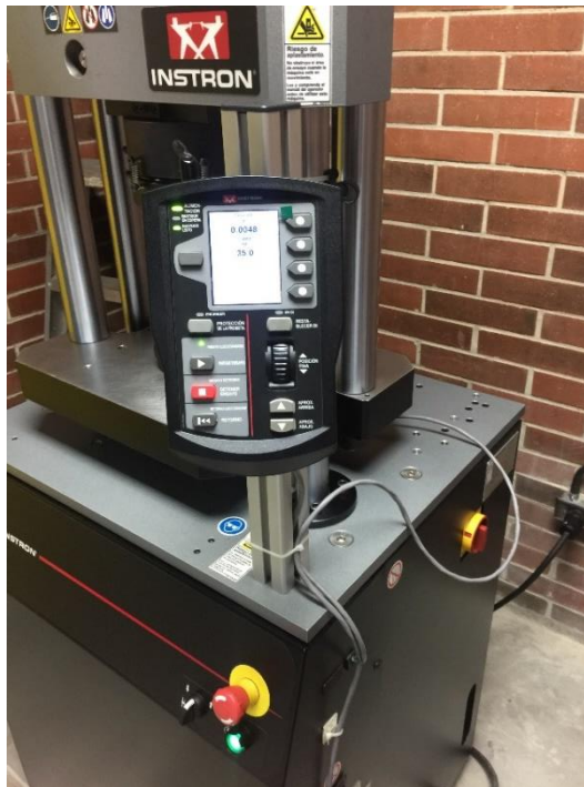
Figura 9. Maquina Universal Instron para ensayos mecánicos. .
