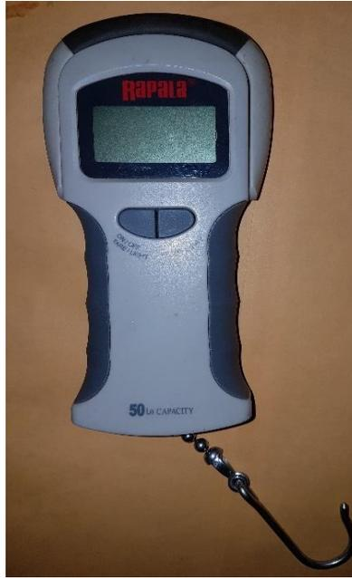
**Figura 13.** Pesa digital Volumétrica (capacidad de 50 lb), utilizada para el pesaje de RDS generados antes y después de la clasificación y caracterización de Residuos y Desechos Sólidos.
