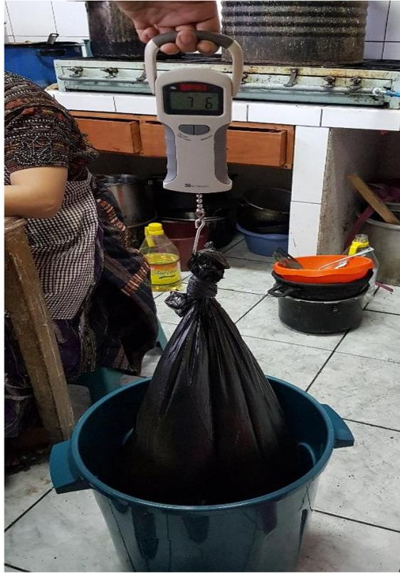
**Figura 20.** Determinación del peso de los RDS.
