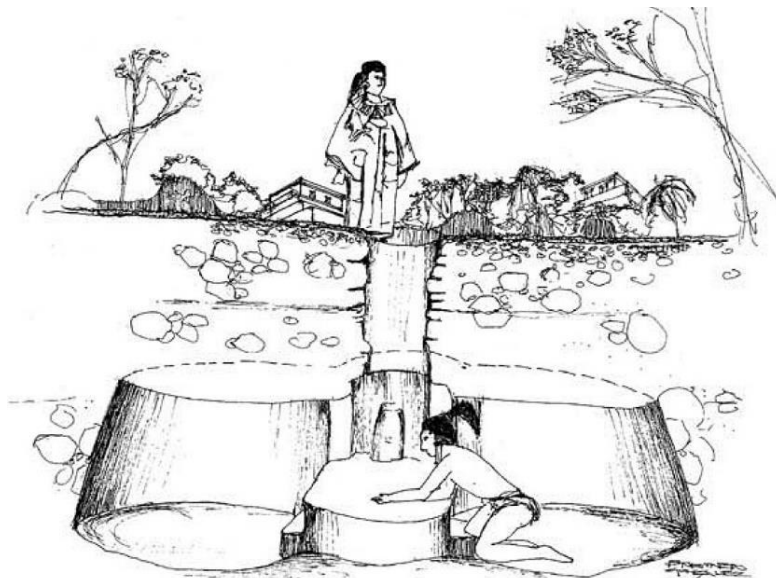
Figura 1. Chultun, sistema tradicional de captación de agua de lluvia de la civilización Maya (Calderón, 2016)
