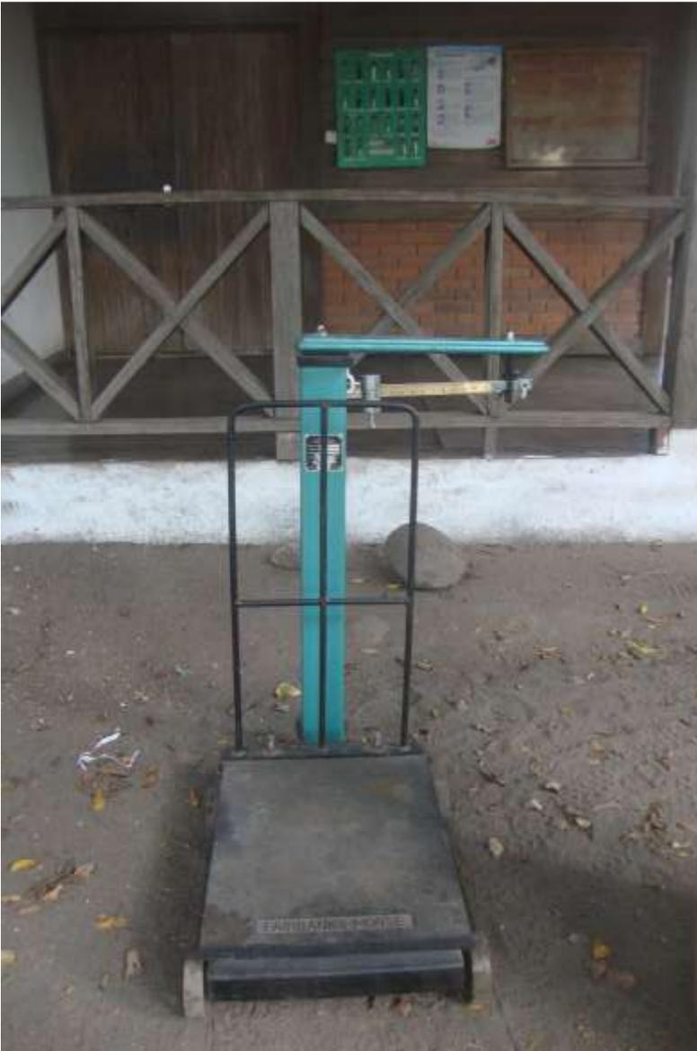
Figura 11. Báscula marca Fairbanks utilizada para el pesaje de los desechos.
