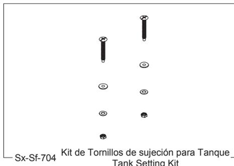
Sx-Sf-704 Kit de Tornillos de sujeción para Tanque
