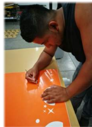
Imagen 37: Vaciado Fuente: propia
