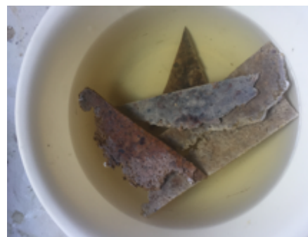
Figura 98, sumersión de retazos de material en agua para prueba de permeabilidad Fuente: elaboración propia
