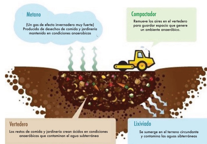
Figura 26, diagrama de generación de lixiviados Fuente: http://bit.ly/2rhGiml
