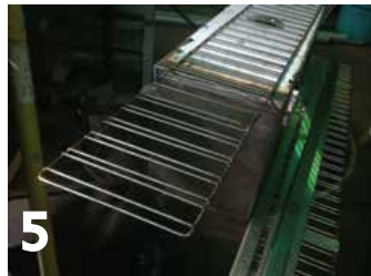
5 Soldadura de varilla larga para la parrilla
