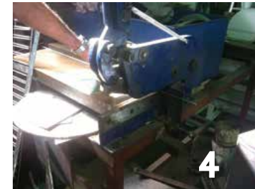
4 Corte de varillas pequeñas para los sostenedores.
