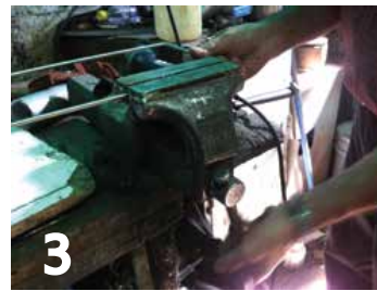
3 Prenzadora, para sostener las piezas y doblarlas con mayor facilidad.
