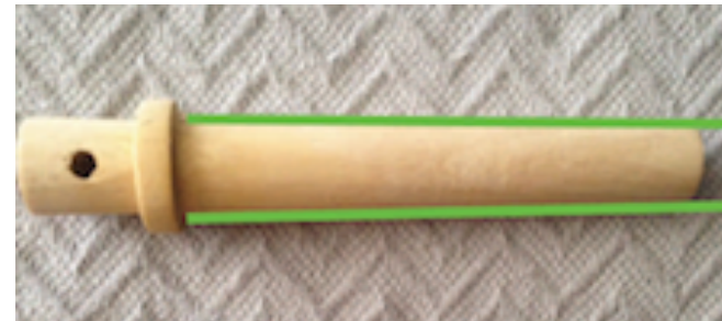
IMAGENS 98 FUENTE: Propia. Forma semi-cónica del molde
