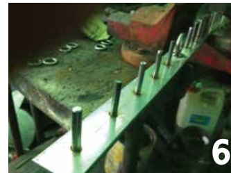
6 Soldadura de varilla pequeña para el sostenedor de los moldes parrilla.
