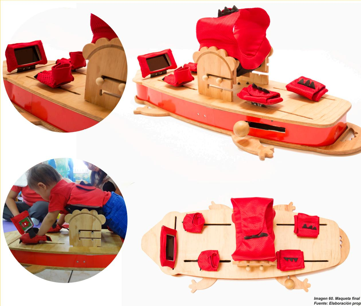
Este prototipo se realizó para probar ya el mecanismo en materiales reales. Se utilizó plywood de pino media pulgada. Los pedales de metal están recubiertos de piezas de tela según la analogía del cocodrilo.
