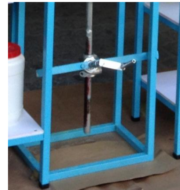
Imagen 13. Mecanismo piñón cremallera. Fuente: elaboración propia.
