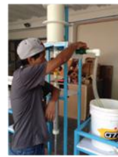
Abre la llave verde, dando paso al agua clarificada
