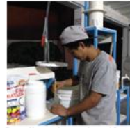
Se disuelve el sulfato de aluminio en agua
