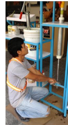
Imagen 26. Sube el pistón con el mecanismo biela-manivela, R. Fuente: elaboración propia.
