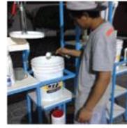
Agregar cal hidratada
