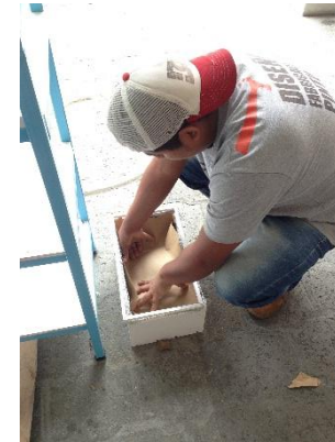
Imagen 23. Coloca el papel kraft dentro de la caja para verter el sedimento. Fuente: elaboración propia.
