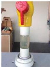
Sedimentación 5 horas por 3 galones. Se observa el agua clarificada
