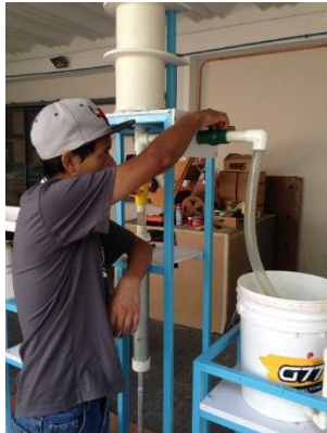
Imagen 27. Abre llave de paso verde, agua clarificada, R. Fuente: elaboración propia.
