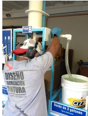
Imagen 21. Abre llave de paso verde, agua clarificada. Fuente: elaboración propia.
