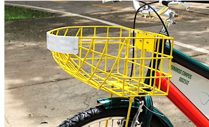
Imagen 142: Canasta de alambre de acero, calibre 9. Fuente: Propia.
