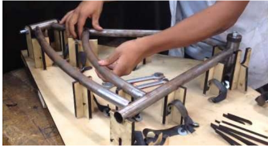
Imagen 93: Alineación en marco de bicicleta. Fuente: https://i.ytimg.com/vi/ryvR43BeG7E/hqdefault.jpg
