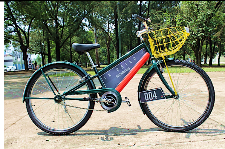
Imagen 123: Referencia de cambios, tubo más grueso, tubo de sillín, identificación, loderas y canasta Fuente: Propia.
