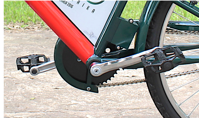
Imagen 146: Pedales de metal tipo trampa de oso. Fuente: Propia.
