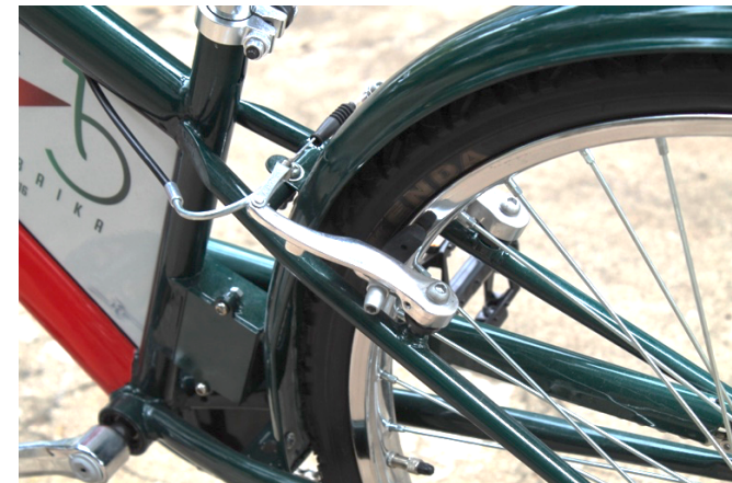
Imagen 143: Juego completo de frenos V-Brake de aluminio. Fuente: Propia.
