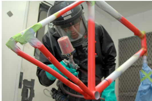
Imagen 94: Pintado de acero con soplete. Fuente: http://biklas.com.mx/images/8570/lloyd-paint-spraying.jpg
