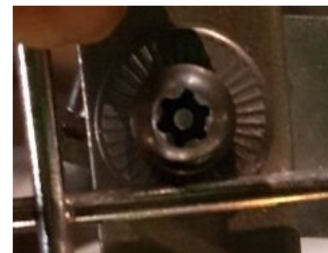
Imagen 32: Tornillo de seguridad tipo trox Vélíb, Francia. Fuente: Propia.
