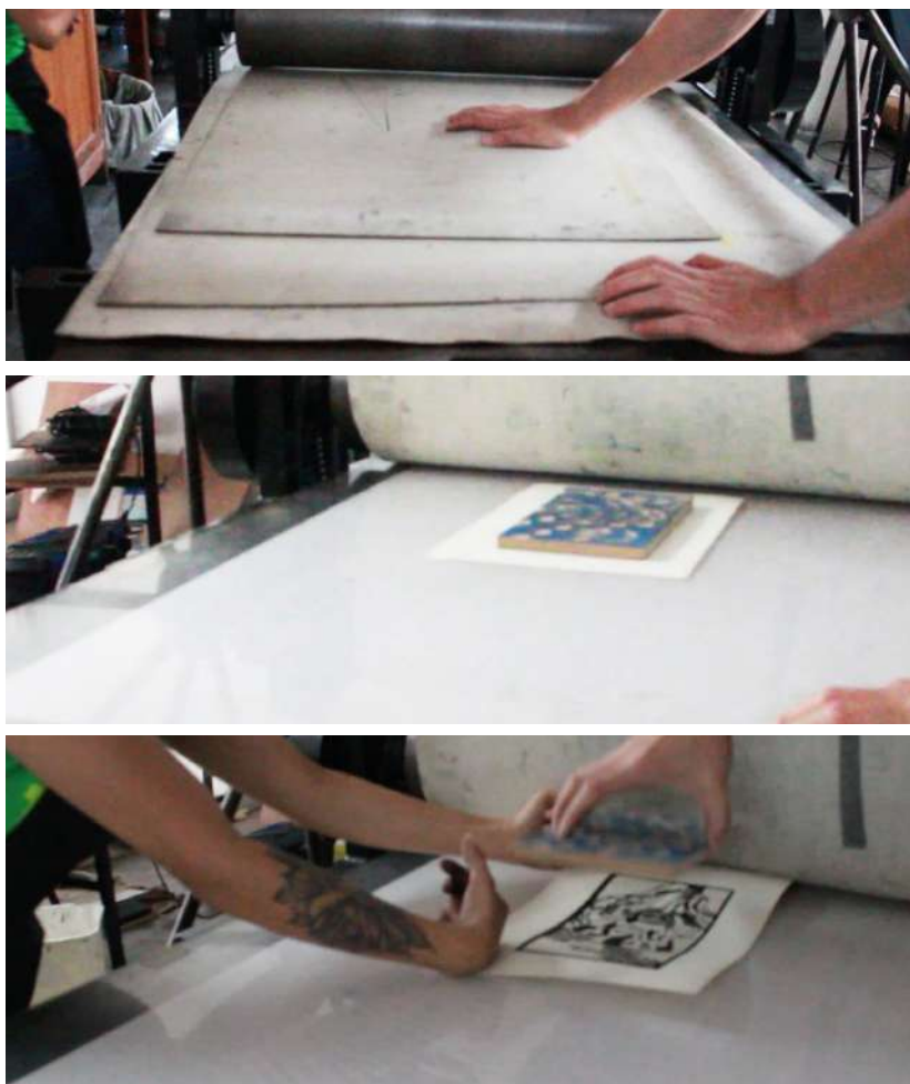
Fig. 195-197. Impresión: Proceso de impresión por tórculo. (Fuente: Rita Corado. Fotografías tomada en abril 2017)
