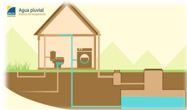
Fig. 31: Esquema de recolección de agua pluvial.
