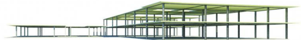
CRITERIO ESTRUCTURAL DE TODO EL COMPLEJO MARCOS RÍGIDOS DE ACERO
