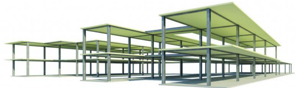
CRITERIO ESTRUCTURAL DE TODO EL COMPLEJO MARCOS RÍGIDOS DE ACERO
