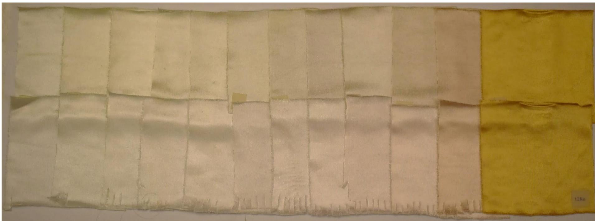
Figura No. 15 Muestras obtenidas en el proceso de aumento de temperatura a 4°C/min desde 30°C hasta 130°C y una última muestra manteniendo la temperatura de 130°C por 45 minutos para el color amarillo 1
