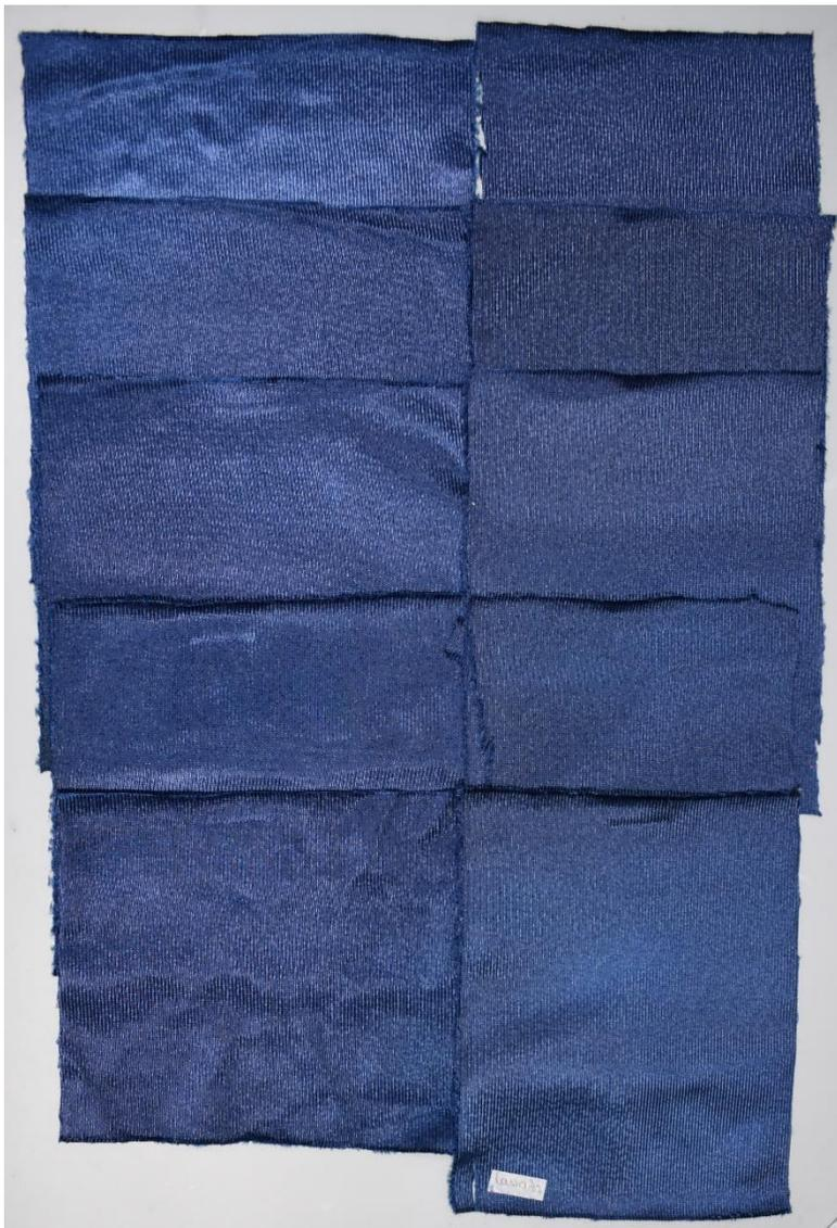
Figura No. 36 Muestras obtenidas cada 15 minutos a 130°C para el color azul 2 comparando los resultados del método actual (izquierda) con el proceso diseñado (derecha)
