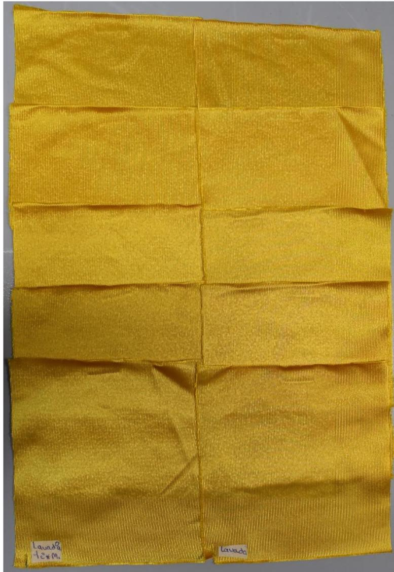
Figura No. 32 Muestras obtenidas cada 15 minutos a 130°C para el color amarillo 2 comparando los resultados del método actual (izquierda) con el proceso diseñado (derecha)
