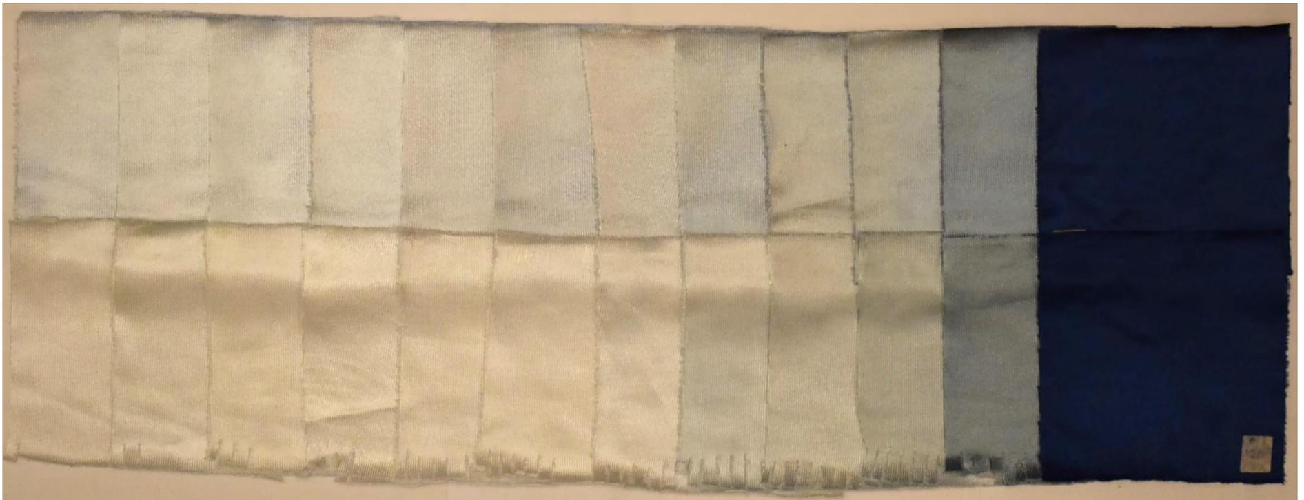
Figura No. 26 Muestras obtenidas en el proceso de aumento de temperatura a 2°C/min desde 30°C hasta 130°C y una última muestra manteniendo la temperatura de 130°C por 45 minutos para el color azul 1
