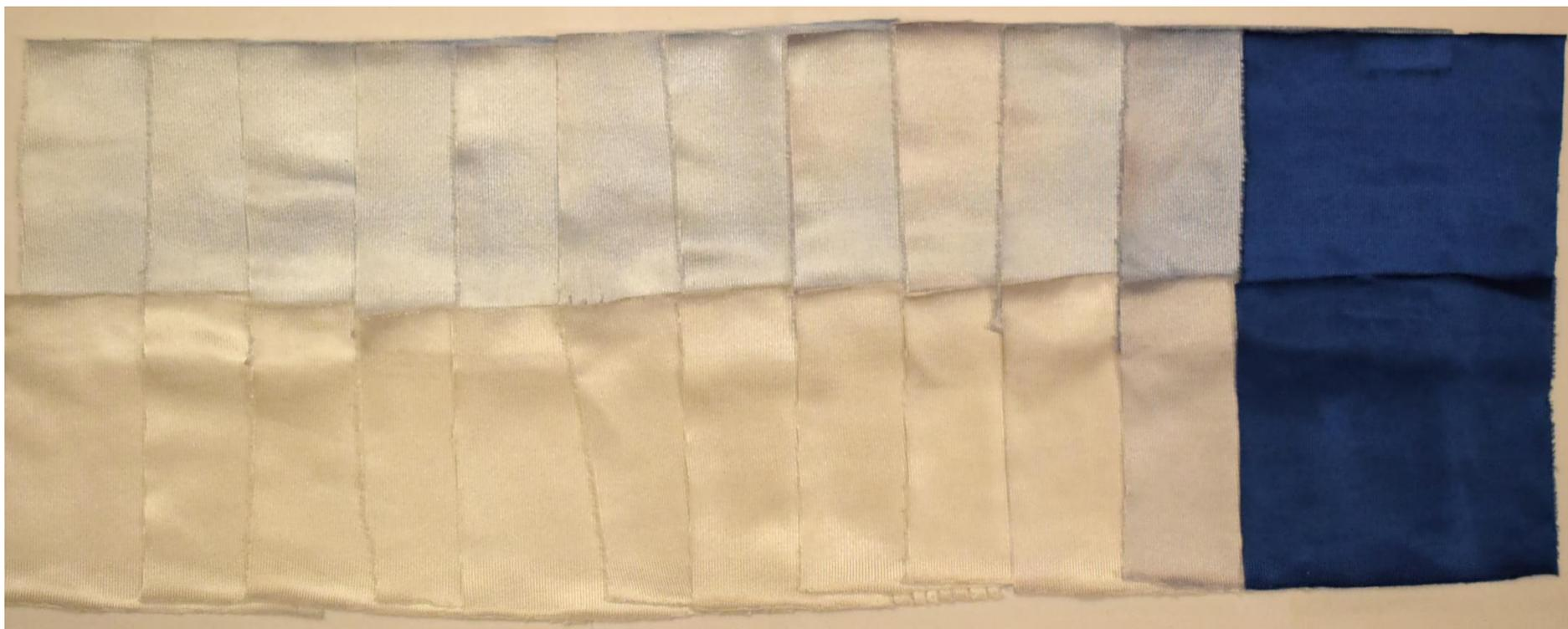
Figura No. 31 Muestras obtenidas cada 15 minutos a 130°C para el color amarillo 1 comparando los resultados del método actual (izquierda) con el proceso diseñado (derecha)
