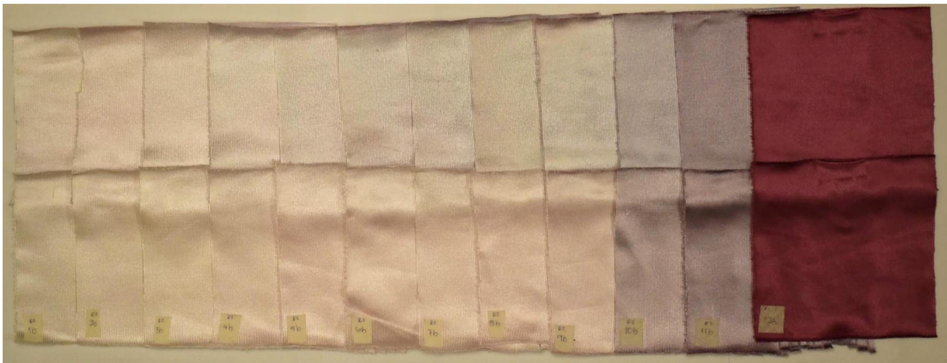
Figura No. 23 Muestras obtenidas en el proceso de aumento de temperatura a 2°C/min desde 30°C hasta 130°C y una última muestra manteniendo la temperatura de 130°C por 45 minutos para el color rojo 2
