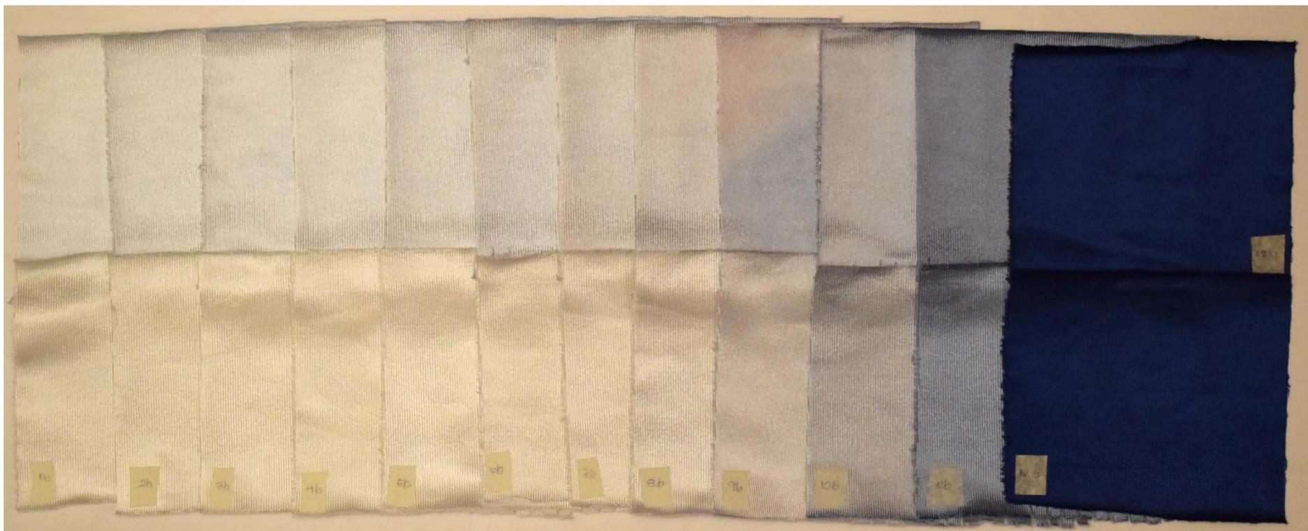
Figura No. 29 Muestras obtenidas en el proceso de aumento de temperatura a 2°C/min desde 30°C hasta 130°C y una última muestra manteniendo la temperatura de 130°C por 45 minutos para el color azul 2
