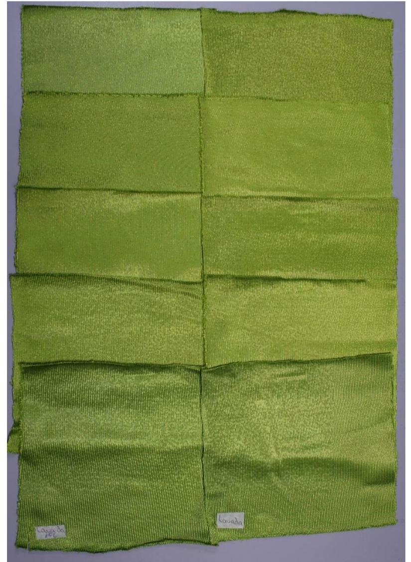
Figura No. 33 Muestras obtenidas cada 15 minutos a 130°C para el color rojo 1 comparando los resultados del método actual (izquierda) con el proceso diseñado (derecha)
