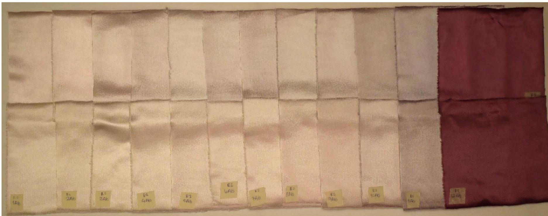
Figura No. 24 Muestras obtenidas en el proceso de aumento de temperatura a 4°C/min desde 30°C hasta 130°C y una última muestra manteniendo la temperatura de 130°C por 45 minutos para el color rojo 2
