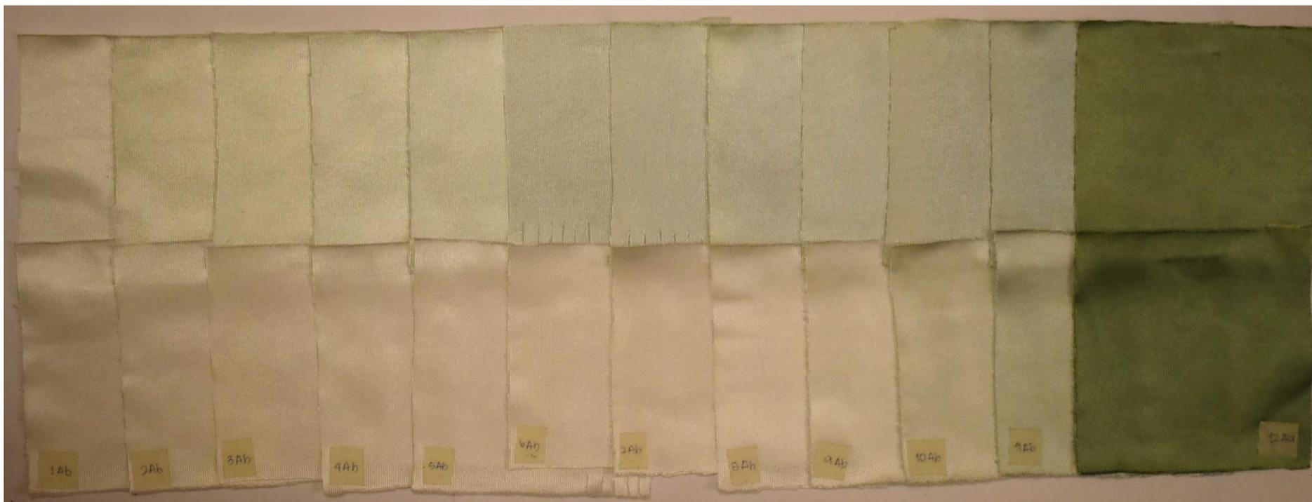
Figura No. 19 Muestras obtenidas en el proceso de aumento de temperatura a 1°C/min desde 30°C hasta 130°C y una última muestra manteniendo la temperatura de 130°C por 45 minutos para el color rojo 1
