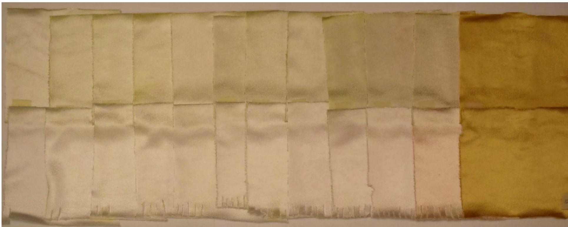
Figura No. 16 Muestras obtenidas en el proceso de aumento de temperatura a 1°C/min desde 30°C hasta 130°C y una última muestra manteniendo la temperatura de 130°C por 45 minutos para el color amarillo 2.
