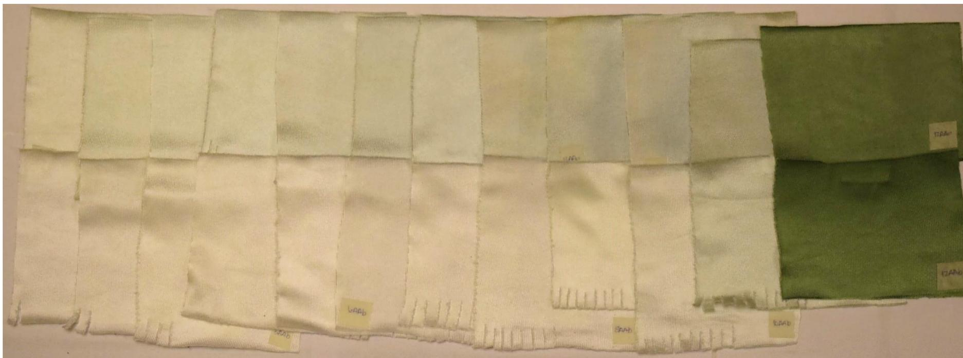
Figura No. 17 Muestras obtenidas en el proceso de aumento de temperatura a 2°C/min desde 30°C hasta 130°C y una última muestra manteniendo la temperatura de 130°C por 45 minutos para el color amarillo 2
