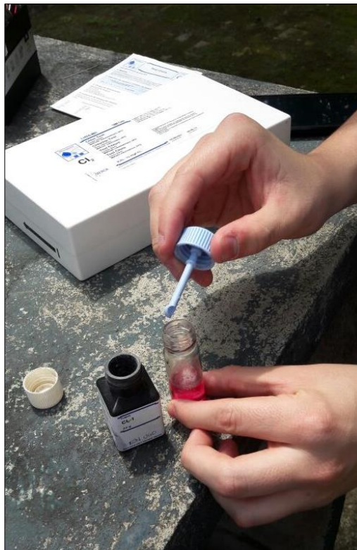
Figura 37. Adición de reactivo DPD a la muestra de solución de cloro.
