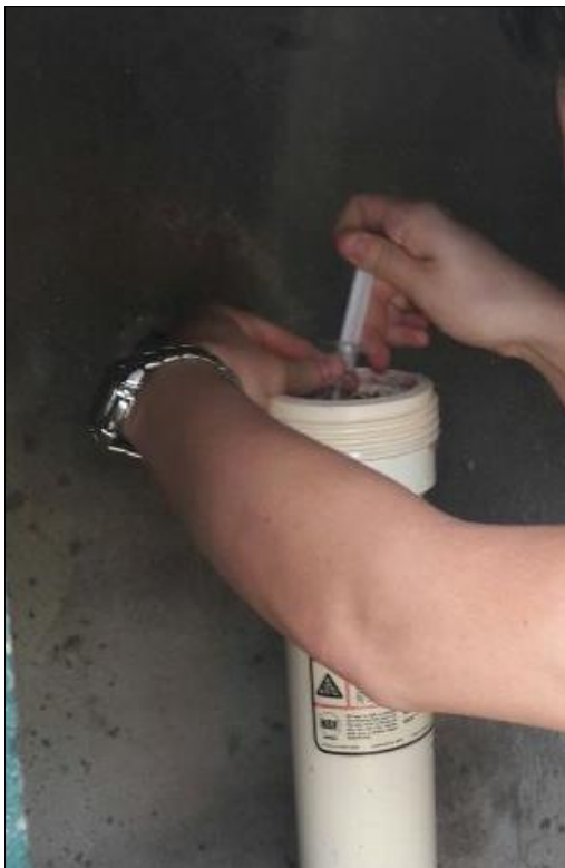
Figura 36. Toma de muestra de solución de cloro del interior del clorador.
