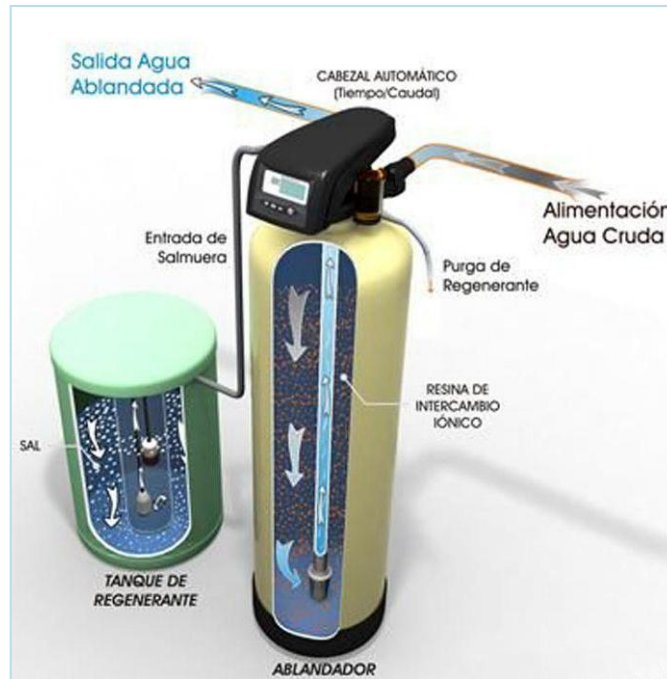
Imagen No. 67: ejemplo de tanque ablandador y tanque con salmuera para regeneración de resina.
