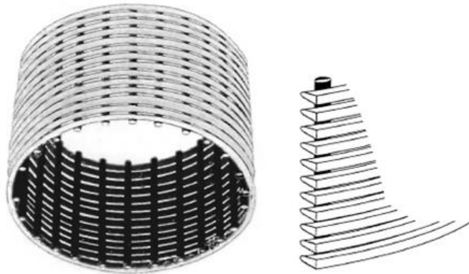
Imagen No. 48: rejilla de cable enrollado.
