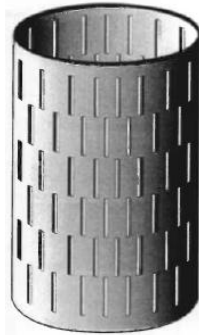
Imagen No. 44: rejilla ranurada verticalmente.
