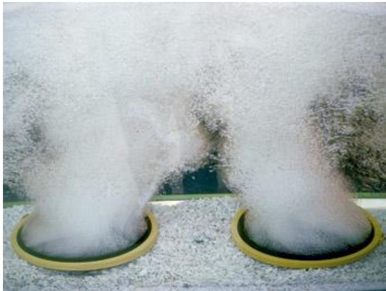
Imagen No. 60: difusor circular de membrana.
