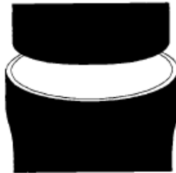
Imagen No. 40: conexión campana-espiga.
