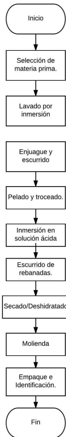
Diagrama 2. Proceso de elaboración de harina a partir de banano verde Elaboración propia (2017)
