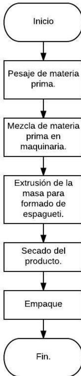
Diagrama 3. Proceso de elaboración de pasta tipo espagueti a partir de la harina de banano verde
