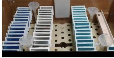
Cámara de niebla salina previo al inicio del ensayo de niebla salina
