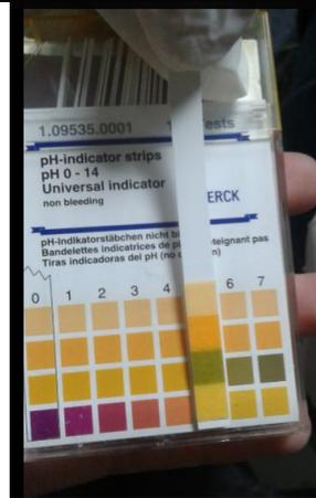
Evaluación del pH de la cámara salina en ensayo de niebla salina
