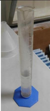
Evaluación del volumen de solución salina aplicada en ensayo de niebla salina
