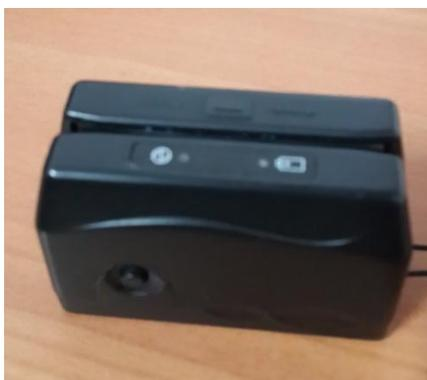
Figura 1: *Skimmer*, dispositivo electrónico a través del cual se obtiene una copia exacta de la banda magnética de otro dispositivo electrónico (tarjeta de débito o crédito) que luego se utiliza para clonar una copia exacta de la banda magnética robada o hurtada, para luego sustraerle su dinero. Foto otorgada por DEIC, PNC.
